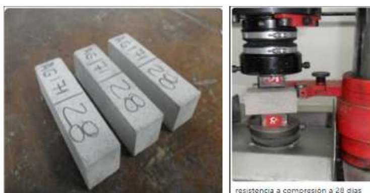
Fig.10 probetas de ensayo de mortero y prensa para compresión
