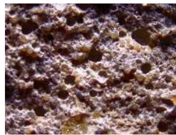
Fig.13 textura del mortero patrón a lupa binocular
