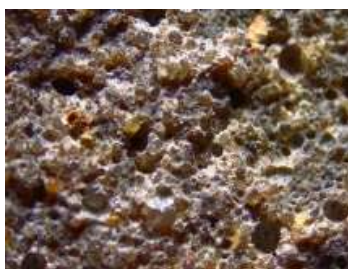
Fig.12 textura del mortero patrón a lupa binocular
