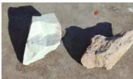
Fig. 3 muestra de mineral zeolita A (izquierda), muestra de mineral de toba C (derecha)
