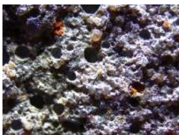
Fig.11 textura del mortero patrón a lupa binocular
