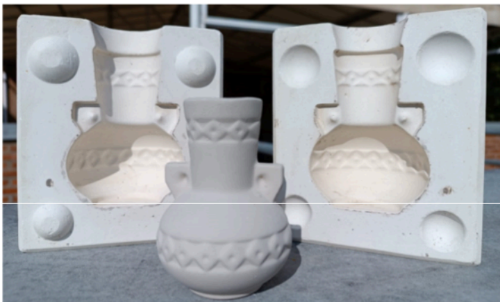
Figura 9. Molde A con la pieza resultante en verde.
