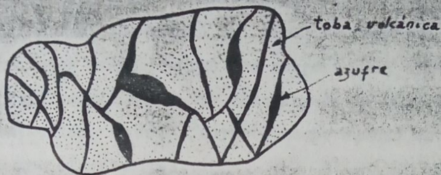
Fig: 4a Azufre rellenando grietas en tobas "craqueladas"
