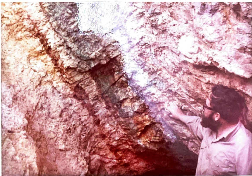
FOT. 8 Detalle de la veta María Eugenia (vista hacia el oeste). 0,70m con 10 %Cu, 0,2 %Zn y 4 grAu/t. El sulfuro dominante es tetraedrita.
