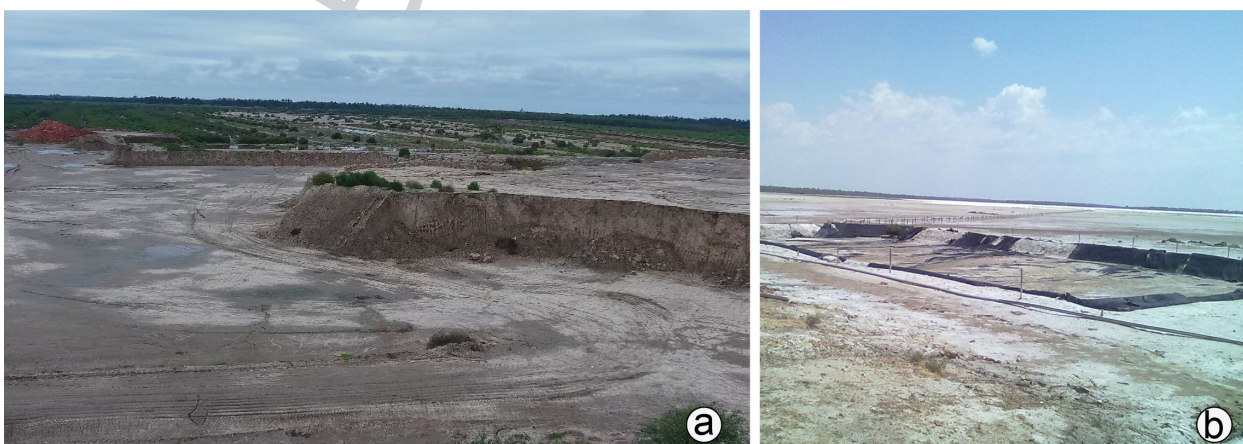
Figura 10. a) Cantera Santo Domingo. En el frente se observa el stock de acopio de material arcilloso. En el fondo de la fotografía se encuentran las labores extractivas. b) Salina de Huyamampa. Se observan piletones utilizados para la producción de las sales de sodio.
