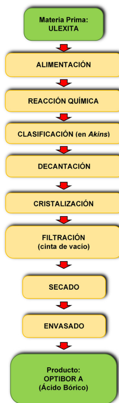
Figura X.7. Esquema de las operaciones en la planta de ácido bórico.
