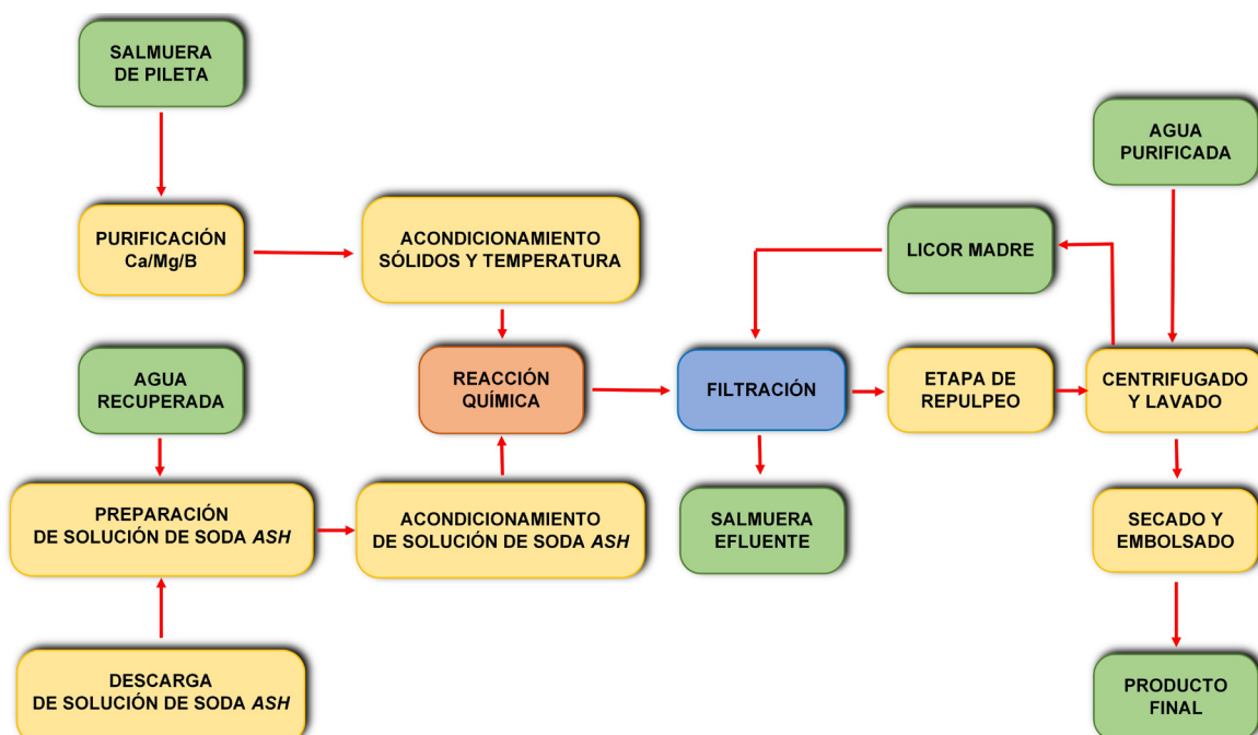
Figura IX.3. Esquema del proceso en la planta de carbonato de litio.
