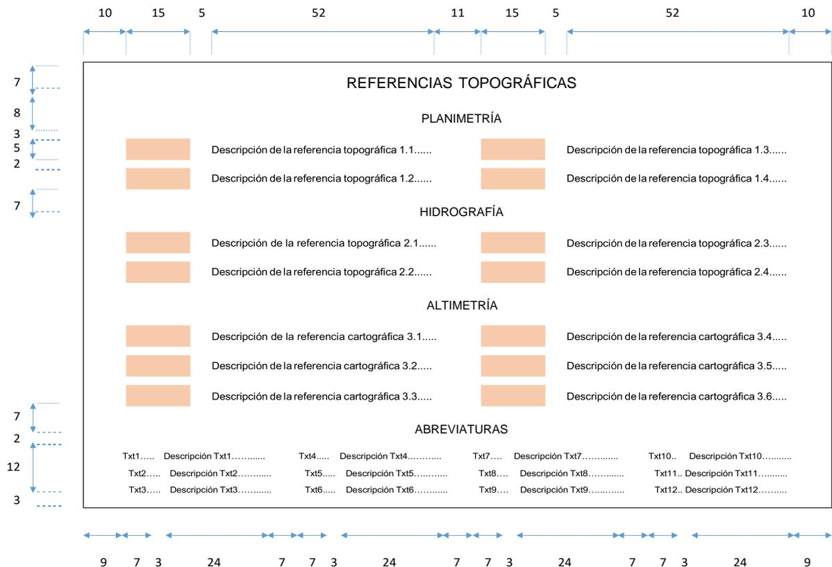
*Figura 8. Dimensiones de las referencias topográficas.
