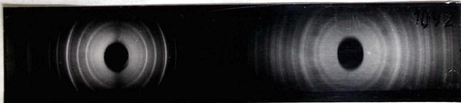
Líneas de mayor intensidad en el diagrama de polvo de rayos X correspondientes a huebnerita (radiación Fe K $\alpha$ , diámetro de cámara 5,73 cm)
