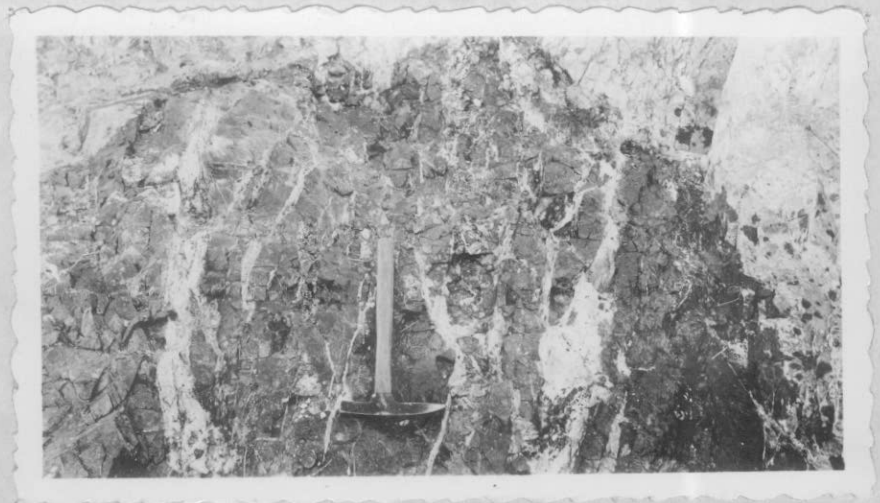
Foto n° 5.- Zona fuertemente triturada en las porfiritas de la margen izquierda.
