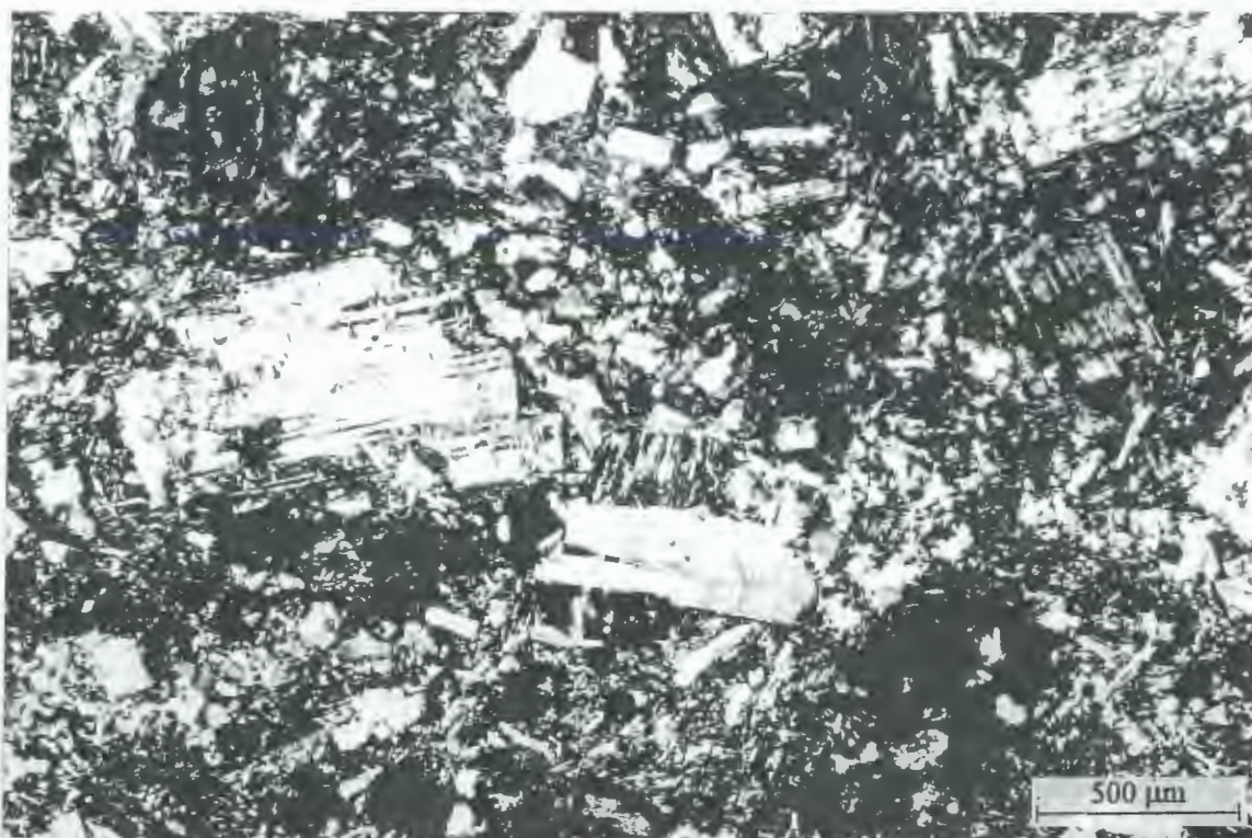
Figura 7. Microfotografía mostrando el aspecto de una andesita perteneciente al Grupo Choiyoi aflorante en el área de Chezanco. Obsérvese la textura microporfírica formada por fenocristales de plagioclasa inmersos en una pasta de grano fino imperfectamente seriada.
