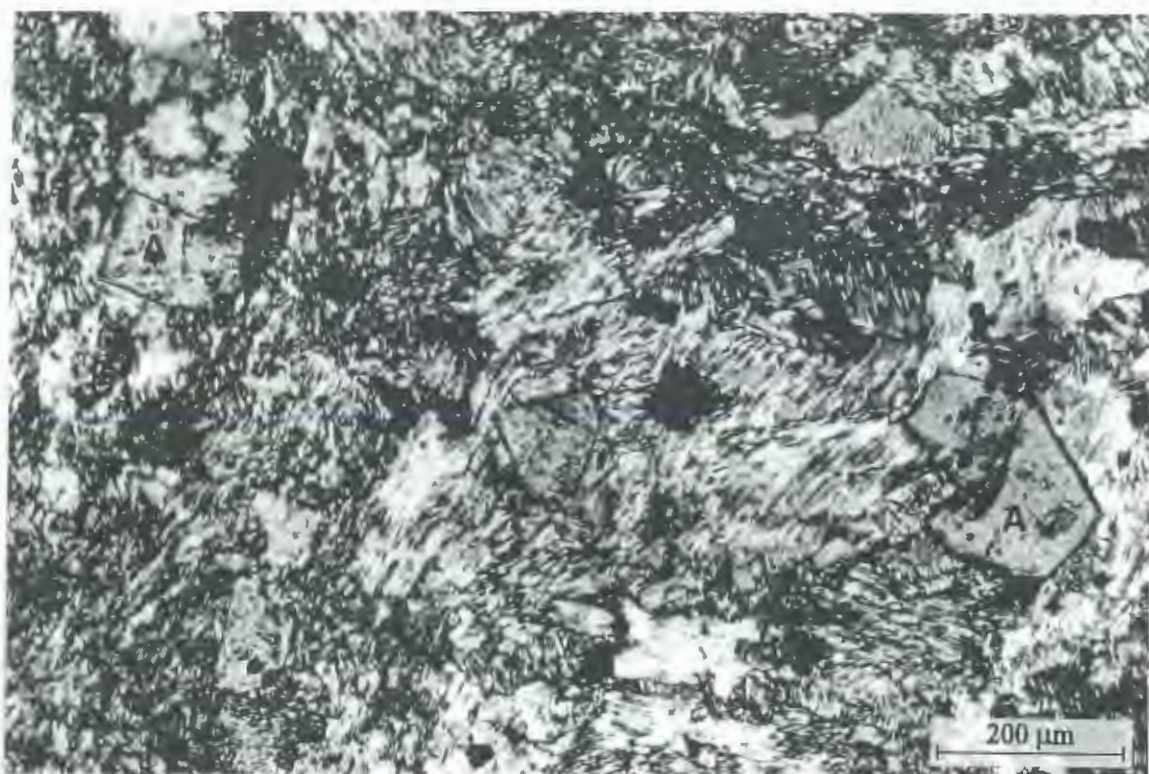
Figura 32. Microfotografía de láminas de yeso fibroso de la parte superior (= Serie del Yeso) de la Formación La Ollita. Obsérvese además la presencia de cristales euedrales de yeso (A).
