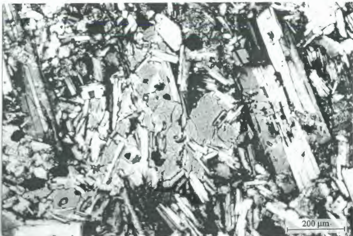
Figura 43. Microfotografía mostrando el aspecto de un basalto incluido en la unidad Andesitas Mio-Pliocenas, proveniente de la margen derecha del arroyo del Zancarrón. Obsérvese la textura subofítica en la que participan microlitos de plagioclasa incluidos en un clinopiroxeno y el bajo grado de alteración que muestra la roca.
