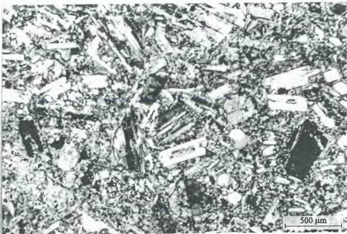
Figura 39. Microfotografía mostrando una andesita con textura seriada perteneciente a los afloramientos aledaños al área de Los Despoblados de la Formación Cerro Las Tórtolas.
