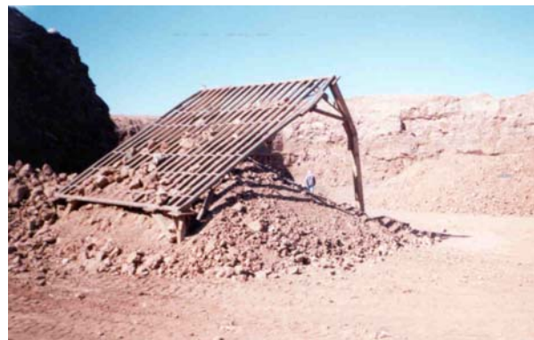
Figura 5. Elizabeth III. Grilla para «tamañado» de bloques.
