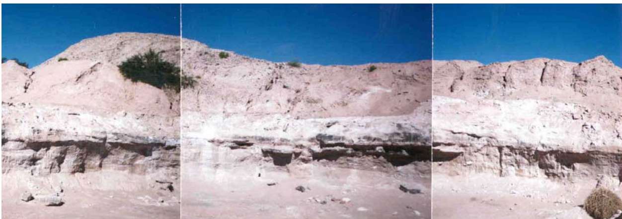
Figura 10. Cantera El Abuelo. Vista panorámica del banco explotable y de los importantes destapes a realizar.
