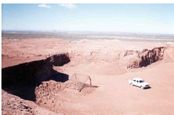
Figura 4. Frente de explotación de la cantera Elizabeth III. En segundo plano se observa el espesor de los destapes.
