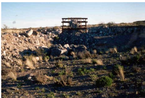
Figura 17. Cantera La China. Material acopiado y grilla para tamañado de bloques.
