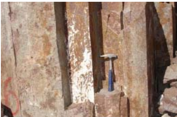
Figura 22. Detalle del diaclasado en ignimbritas riolíticas del frente de explotación de la Cantera Siracusa.
