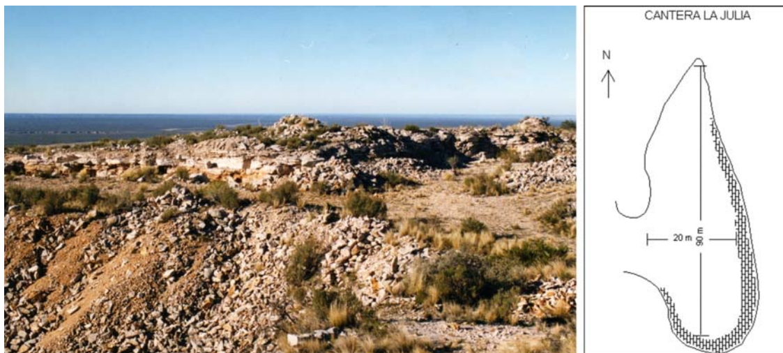
Figura 39. Fotografía del frente de la labor principal de la cantera La Julia y croquis en planta de la labor.
