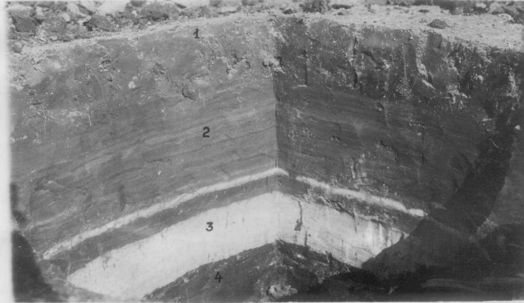
Aspecto de la pared del pozo N°.1 de Toro Yacu, mostrando: 1) Tierra negra turbosa, 2) Estrato de turba terrosa superior, 3) Capa de ceniza volcánica, 4) Estrato de turba terrosa inferior, de 1,45 de espesor.
