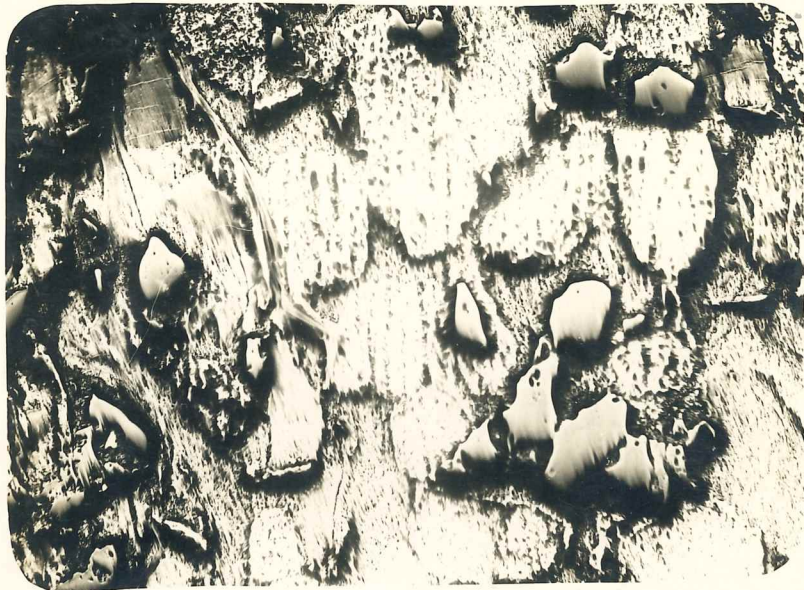
1.- Microfotografía calcográfica. x 100.- Mineral del arroyo de la Hondura. Se nota claramente la estructura granosa de la mena. Hematita: en granos alargados con superficie punteada. Cuarzo: en granos de contornos irregulares, de superficie lisa, sombreados y mostrando relieve.-
