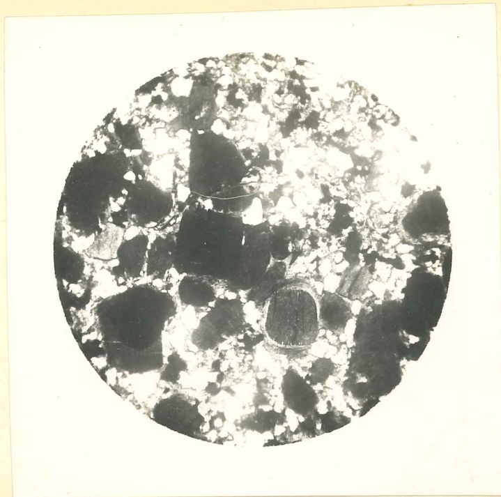
1.- Arenisca thuringítica del río de las Capillas. x Sin nicóles cruzados. Thuringita en granos oscuros, uno de ellos colfítico, siendo su parte central el mismo mineral con clivajes. Cuarzo en granos blancos, entre los que se presenta el material clorítico como cemento.-
