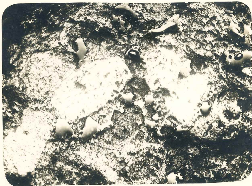
2.- Microfotografía calcográfica. x 100.- Mineral del abra de los Tomates. Masa hematítica con granos blancos alargados de hematita y blancos grisáceos, sombreados e irregulares de cuarzo.-
