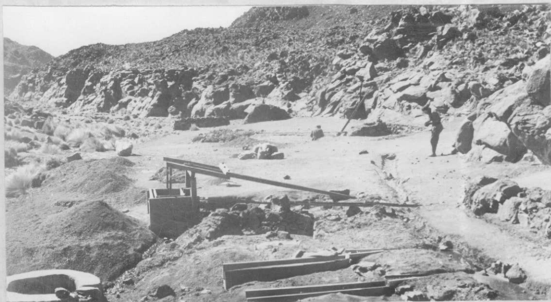
1.- Canaletas, maritata y buddle utilizados en la concentración de los minerales chancedos de las minas "Esperanza" y "Rosa".-
