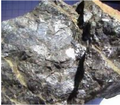
Foto 3: Agregado de cristales de grano grueso de marmatita.
