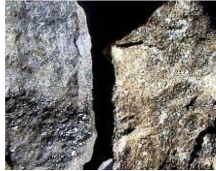
Foto 9: Marmatita y Galena (izq), Esfalerita (der), todas de grano muy fino (< 1mm). Open pit
