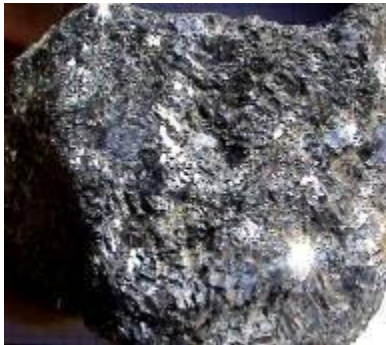
Foto 3: Agregado de cristales de grano grueso de marmatita.
