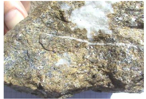
Foto 4: Agregado de cristales de grano grueso de esfalerita con calcita subordinada.
