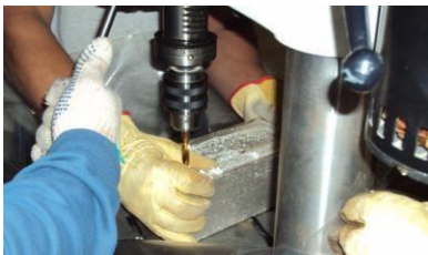
PERFORACION DE LINGOTE
