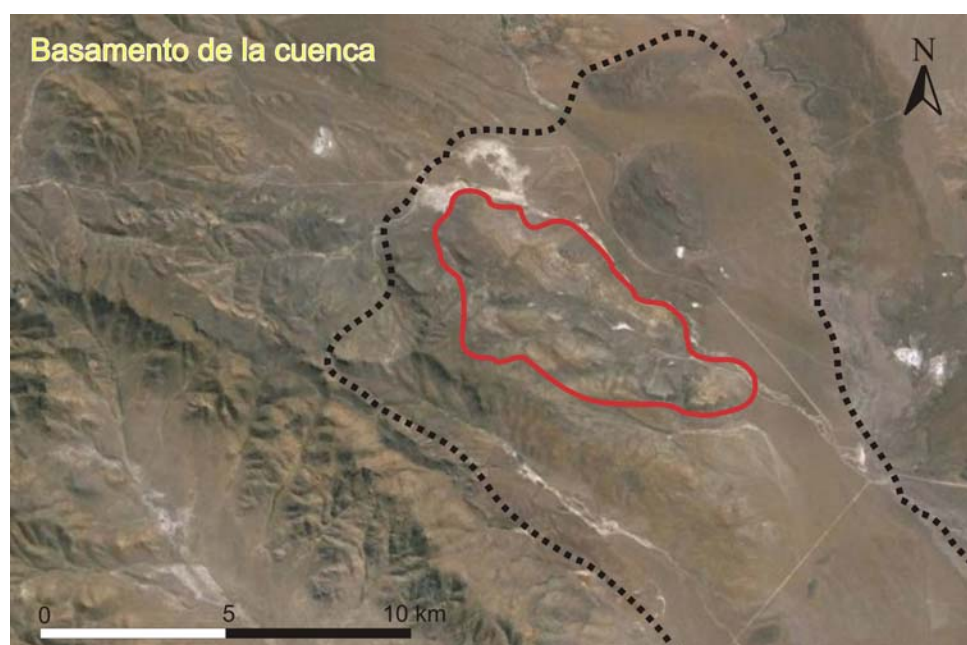
Figura 9. Imagen satelital que muestra la ubicación del área mineralizada de Navidad (línea roja) en el extremo noroeste de la cuenca de Gan Gan; la superficie delimitada por la línea negra corresponde a las rocas de la FCA y su zona externa marca la ubicación del basamento de la cuenca y de la FG.
