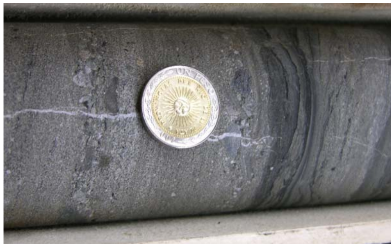
Figura 20. Mineralización de calcita/baritina en delgadas venillas que atraviesan en forma discordante los niveles de sedimentos volcanogénicos, arenosos y pelíticos con carbón. Se destaca la ausencia del brechamiento.
