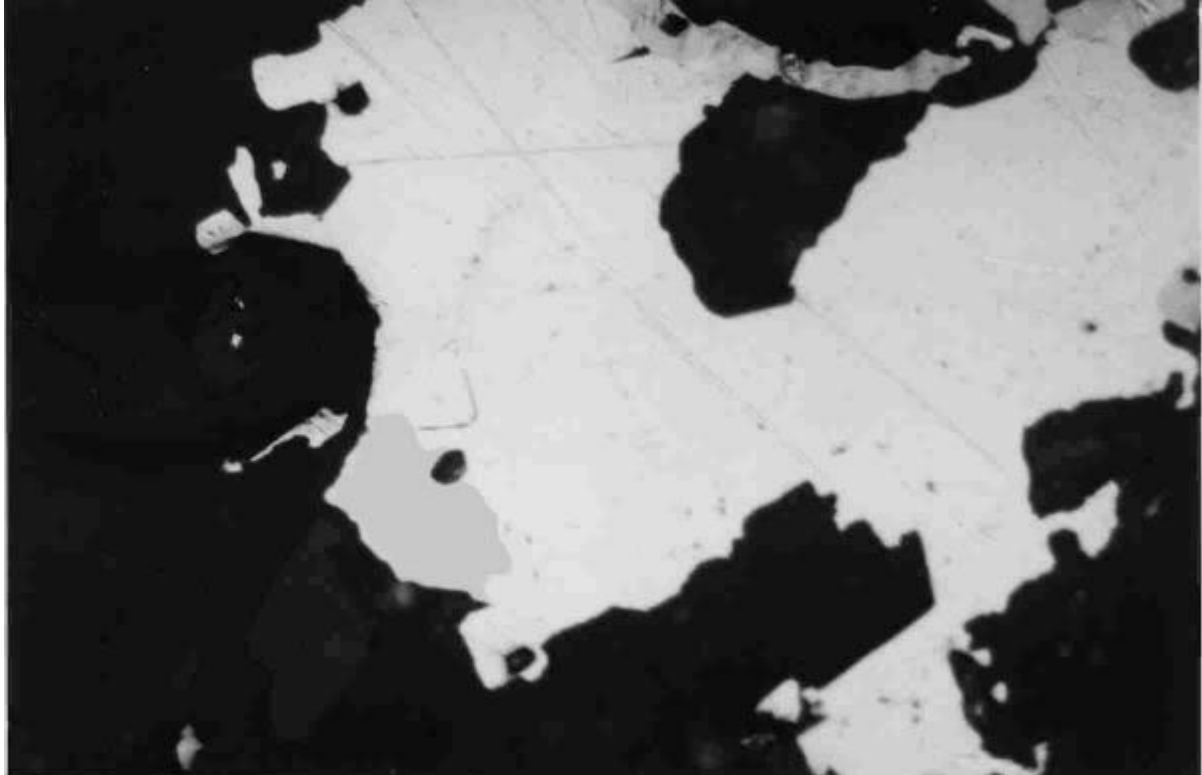
Foto 13, La Chilca. Microfotografía que muestra galena y calcopirita.
