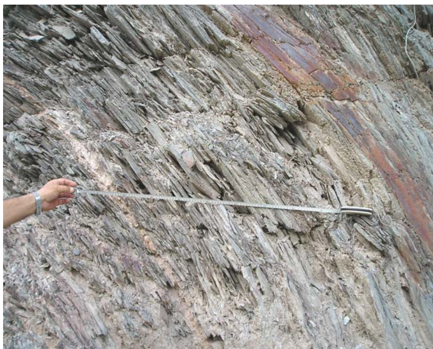
Figura U.L. 8 : Detalle del espaciado de la esquistocidad en un talud al oeste de Bazán.
