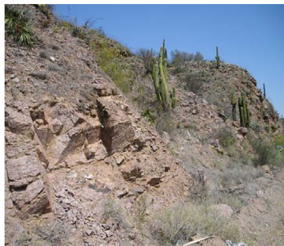
Figura U.L. 6 : Diaclasas abiertas, planas lisas, moderadamente juntas y de baja continuidad.
