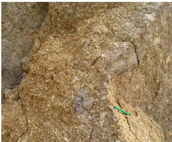
Figura U.L. 5 : Macizo rocoso por el cual atraviesa la ruta N° 60 que pasa por Villa Mazán. Se observan las diaclasas planas lisas, moderadamente juntas y parcialmente abiertas.
