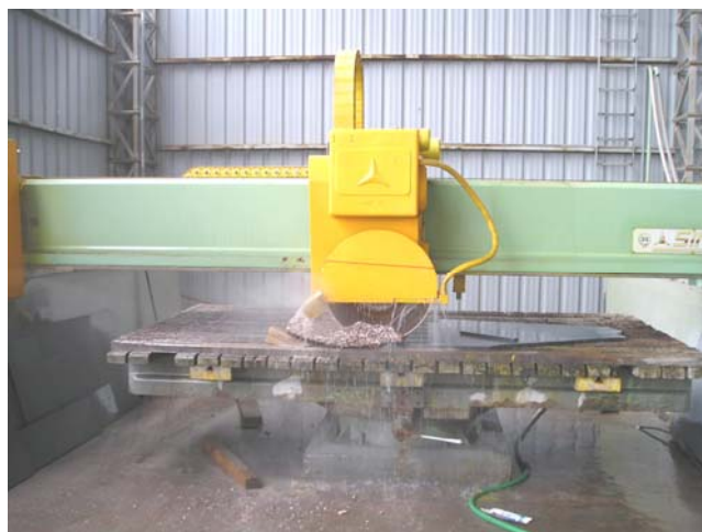
Figura UL.1: Corte de las muestras de rocas realizadas en el aserradero de La Rioja. Las Unidades se diferenciaron según su génesis registrándose cuatro grandes grupos (ver cuadro 1). Dentro de cada uno de estos se clasificaron y separaron según las características litológicas y físico-mecánicas de los materiales.
