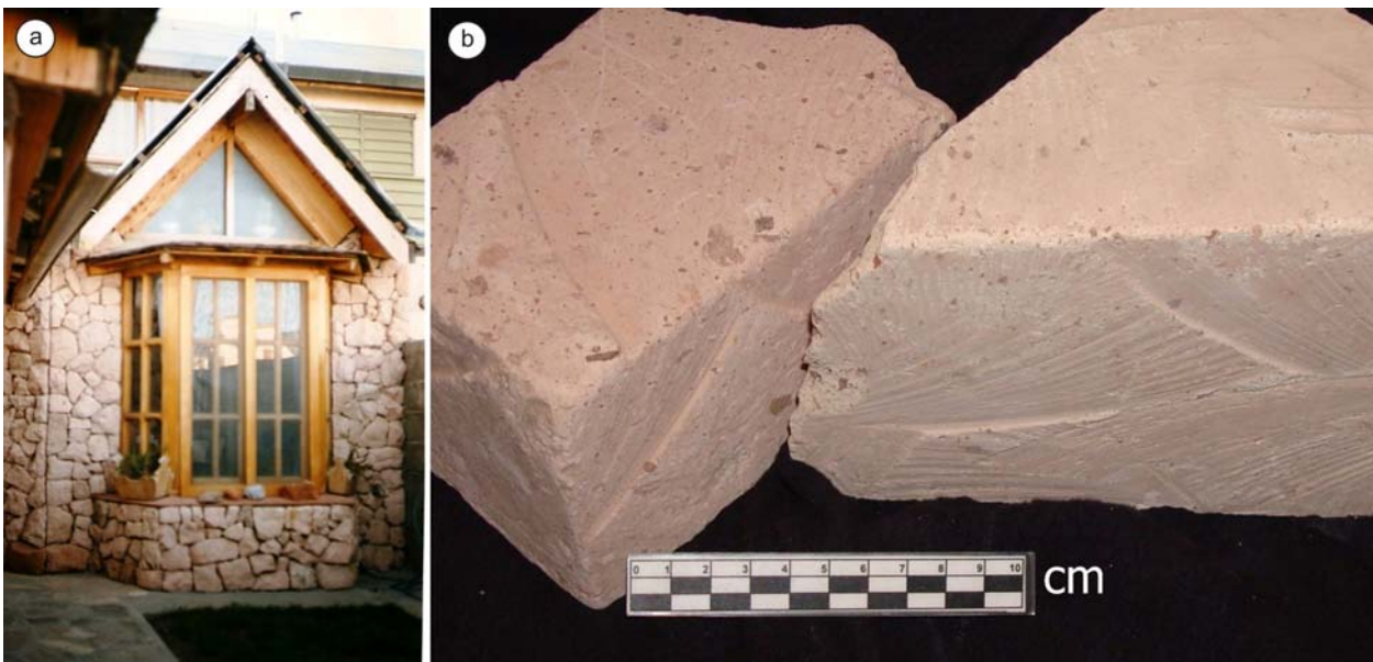
Figura 41. Tobas de Mallín del Indio. a) Revestimiento de mampostería en toba rosada. b) Bloques elaborados con toba rosada.
