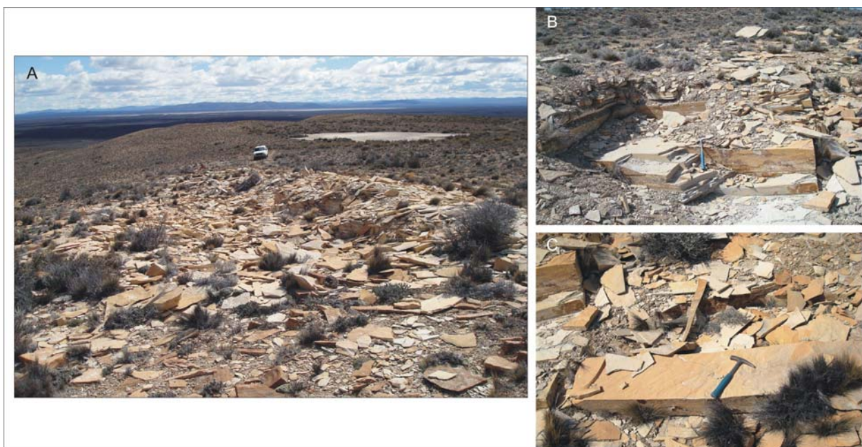
Figura 33. Cantera de piedra laja Cerro Bayo. A) Labores de la parte superior de la lomada del Cerro Bayo. B) Detalle de la estratificación de los afloramientos. C) Geometría y dimensiones de las lajas.
