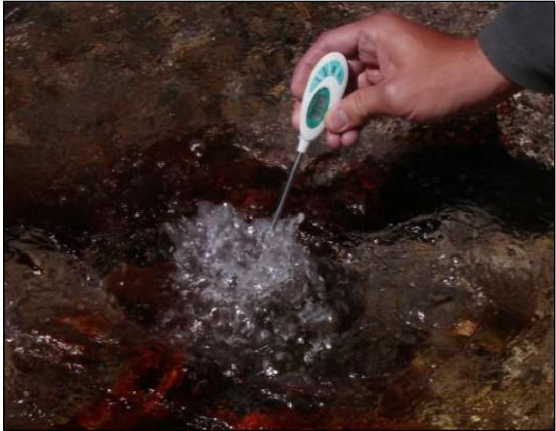
Foto 12: Obsérvese el burbujeo de gases que midió una temperatura de 83.4°C.
