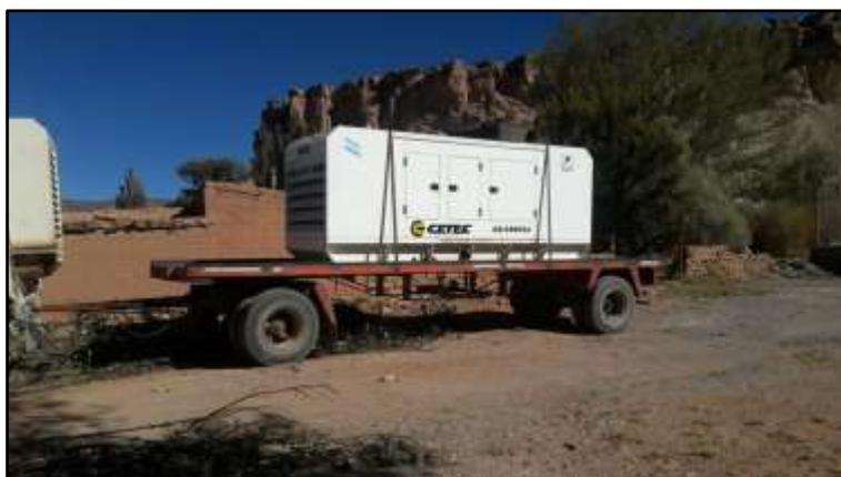
Foto 18: Grupo electrógeno nuevo marca CETEC de 0.25 MWe
