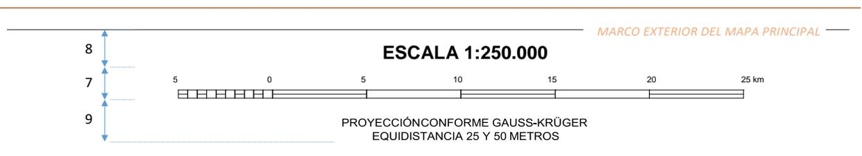
*Figura 17. Dimensiones y distribución de los elementos de la escala.
