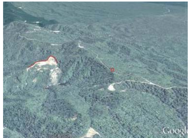
Figura 72: Imagen Google en 3D, donde se ubica un gran movimiento en las sierras de San Antonio. La zona de arranque del deslizamiento esta marcada en rojo. En rojo se señala la fotografía del movimiento obtenida desde la ruta.
