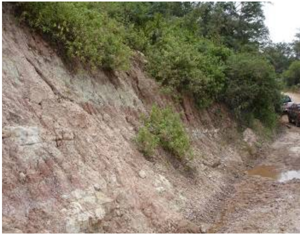
Figura 18: Bancos de pelitas rojas y grises con intercalaciones de bancos de areniscas. Sector de la ladera inestable.
