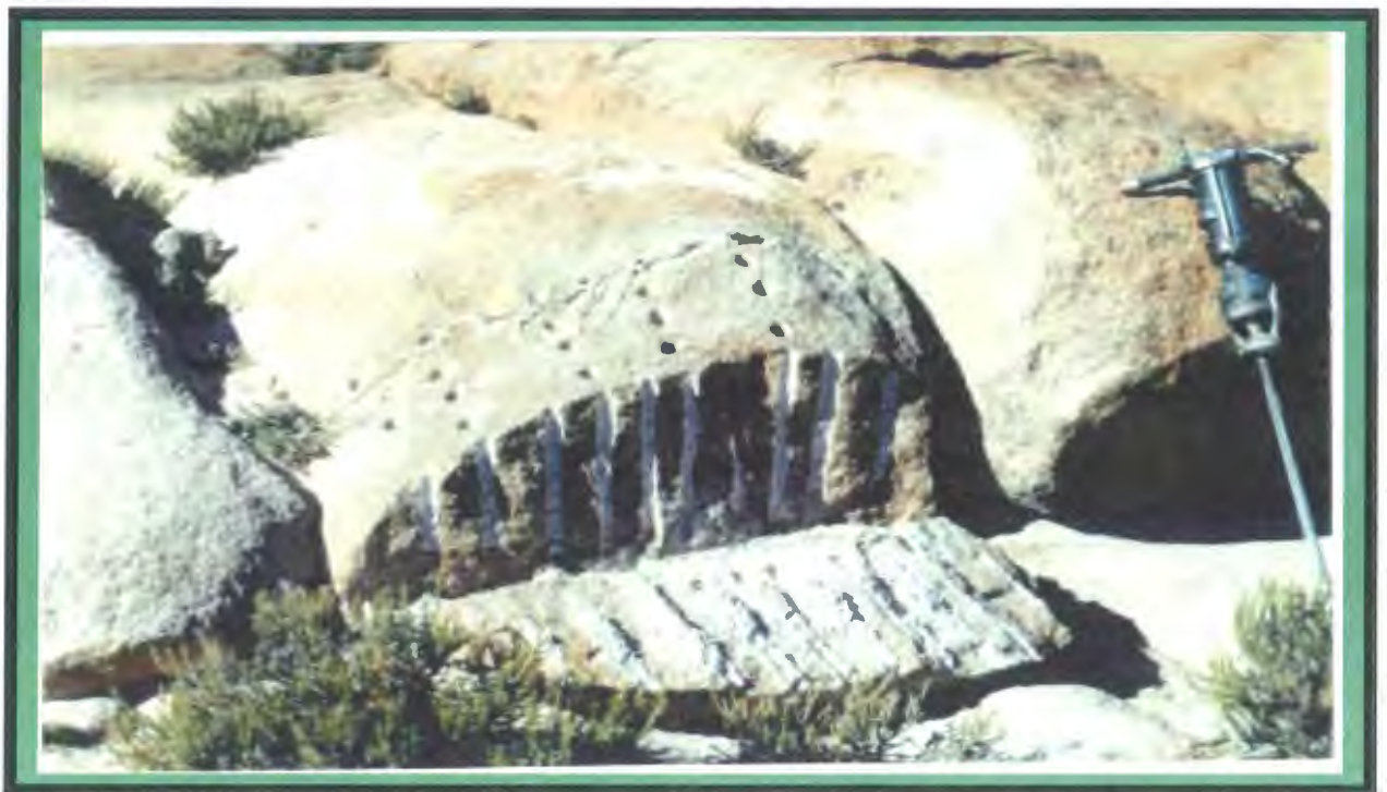
Granito Calvo –Estancia Tomás Calvo. Barrenos rellenos con barro expansivo.
