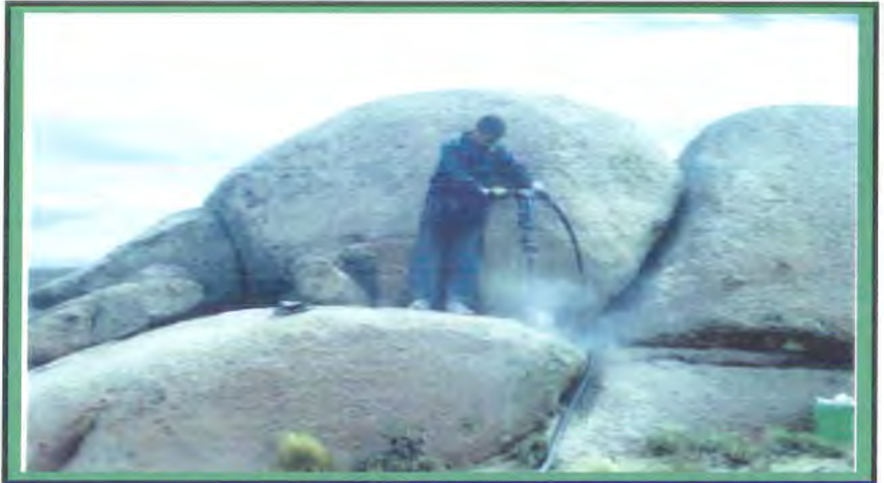
Granito Calvo – extracción de la muestra.
