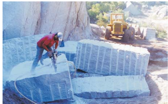
Foto DC-BA-002: Canteras Charquina, recorte de bloques de "gris mara"
