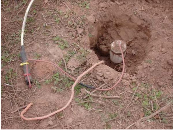
Figura 9: Imagen de un electrodo impolarizable correspondiente al arreglo de registros para bajas frecuencias MT
