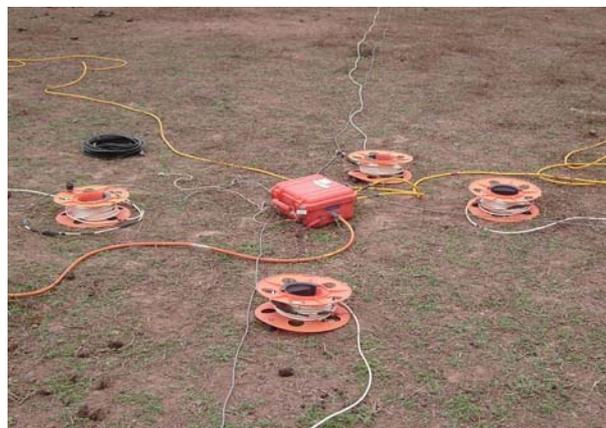
Figura 8: Fotografía donde se observa el nodo de conexión de los 2 sensores magnéticos (barras Hx y Hy) con orientación N-S y E-W, y los 4 dipolos (Ex e Ey) con orientación N-S y E-W
