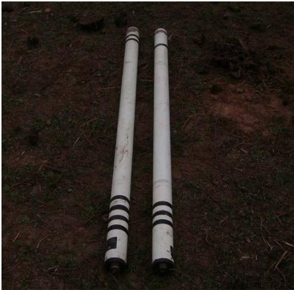
Figura 10: Imagen de las barras de lectura del campo magnético de baja frecuencia. La barra izquierda está señalizada para ubicarse en sentido E-W y la barra de la derecha para una ubicación en sentido N-S
