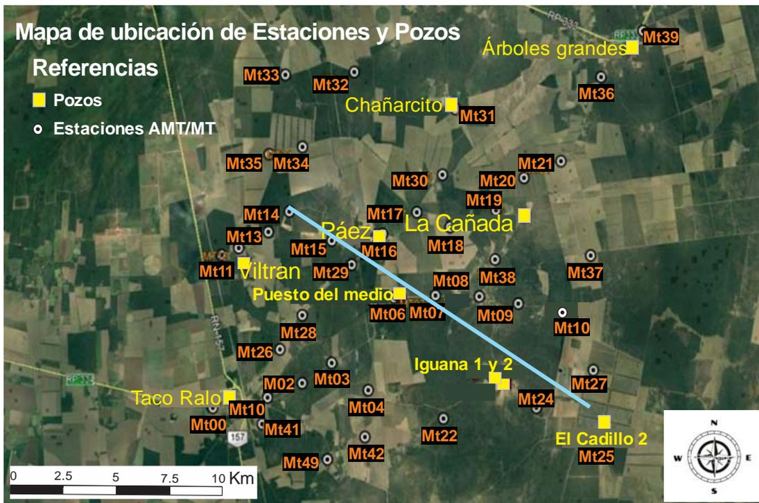
Figura 19b. Imagen satelital que muestra la línea geoelectrica que despliega a la Pseudosección F.
