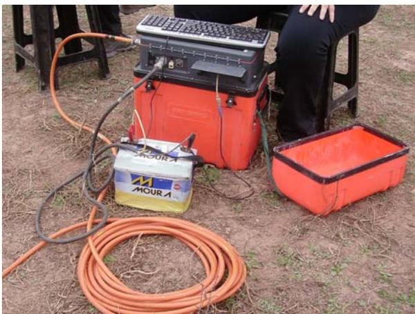
Figura 7: Fotografía donde se observa el Logger de medición Stratagem EH4-II con una batería de alimentación de 12 volts
