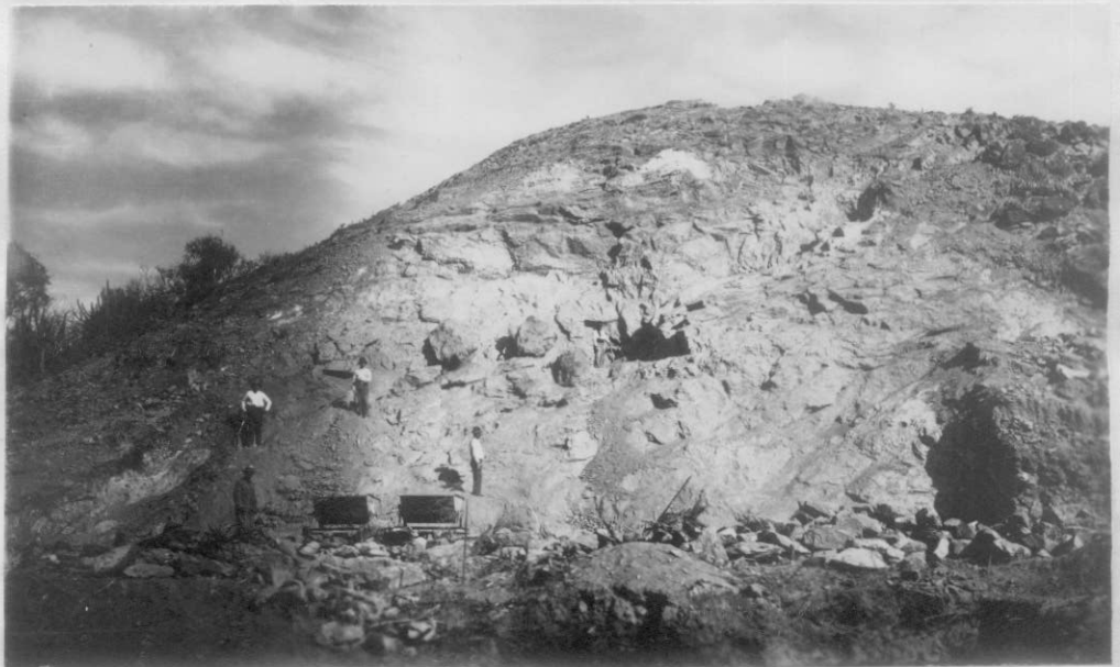
Fot. 2 - Detalle del bloque de la margen izquierda, micacitas. Inclinación fuerte de los esquistos hacia el arroyo y planos de diaclasas.
