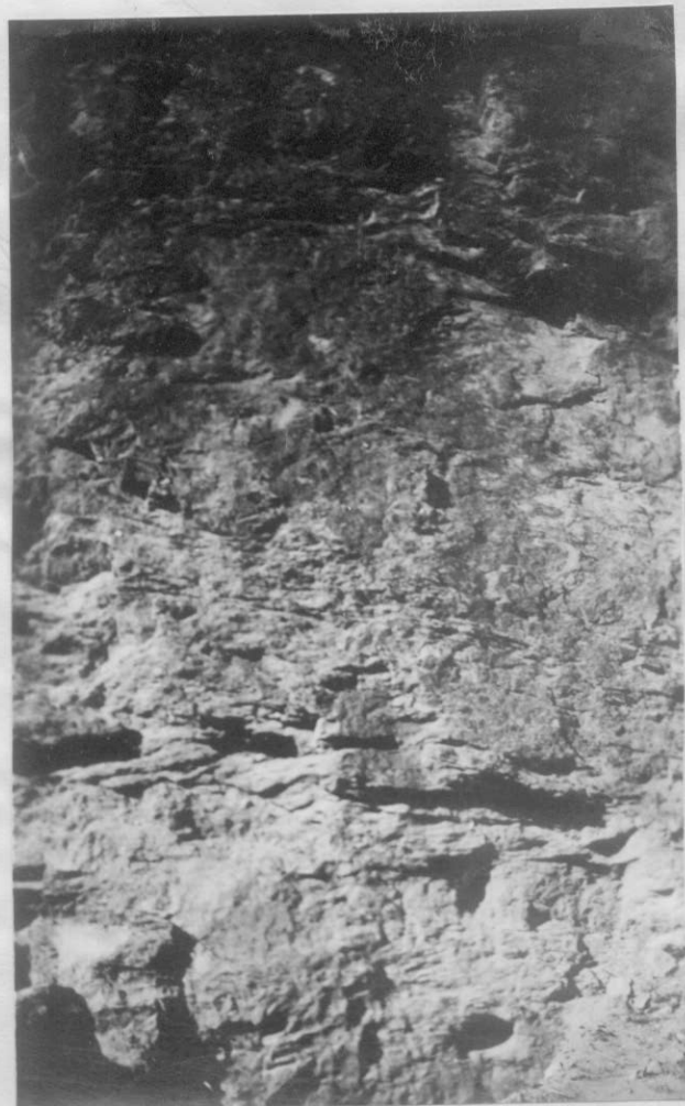
Fot. 1 - Vista del bloque del empotre del margen derecha, desde la margen izquierda. Micacitas con grandes diaclasas.
